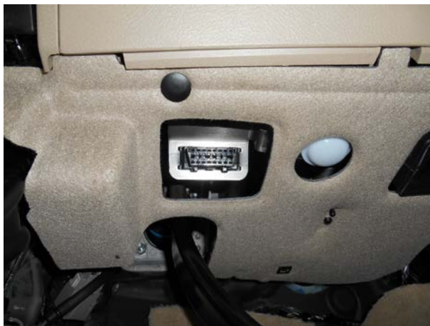
Вытащить разъем OBD из гнезда и снять панель над педалями.
