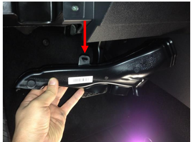
Вывернуть саморез и снять воздуховод.
