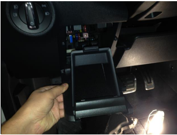
Снять перчаточный ящик.
