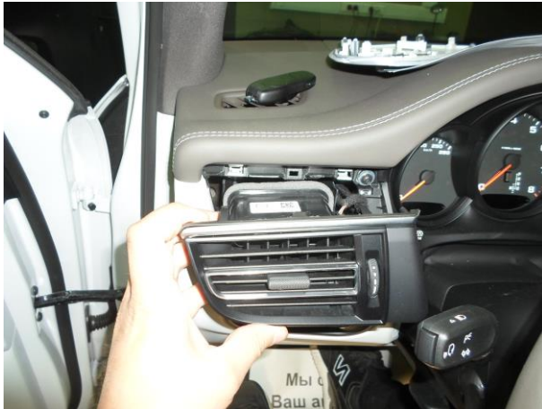
Спец. инструментом выдернуть дефлекторы.
