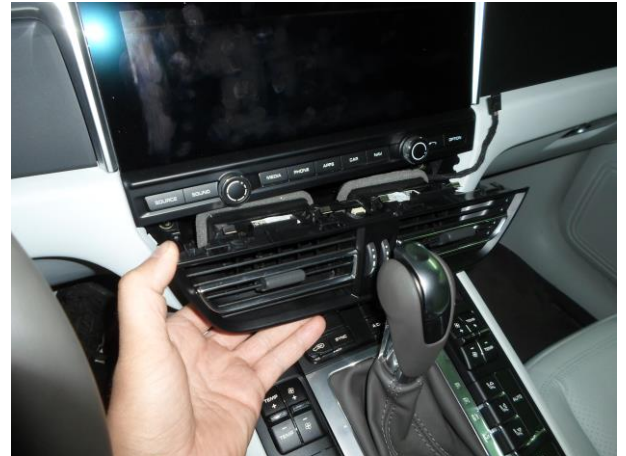
Спец. инструментом выдернуть дефлекторы.
