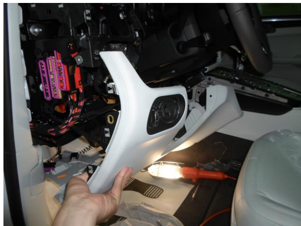
Снять панель, отсоединить фишки.
