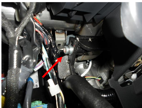
Притянуть верхнее крепление срывным болтом.
