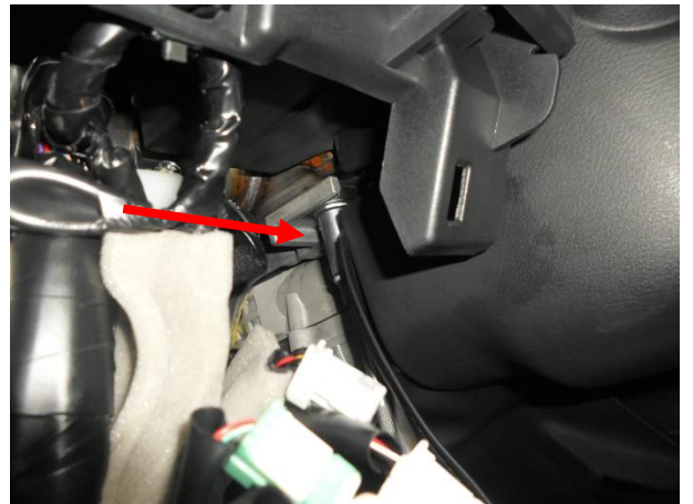
Отвернуть гайку крепления рулевой колонки.
