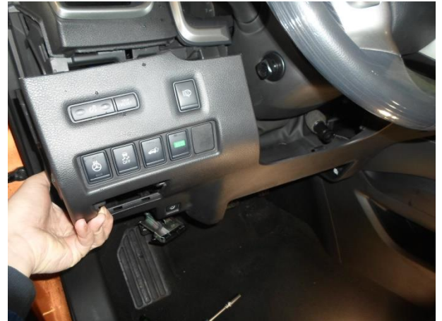
Снять панель, отсоединить фишки.
