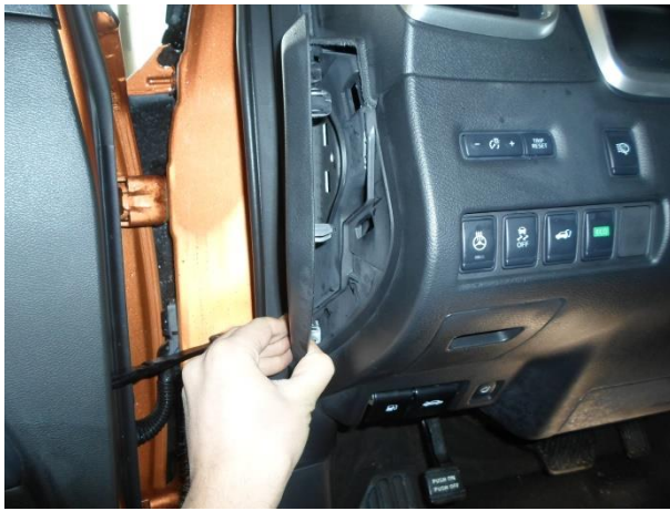
Снять боковую панель.
