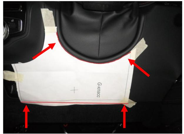
При помощи трафарета из комплектации разметить панель. Выполнить отверстие Ø20 мм.
