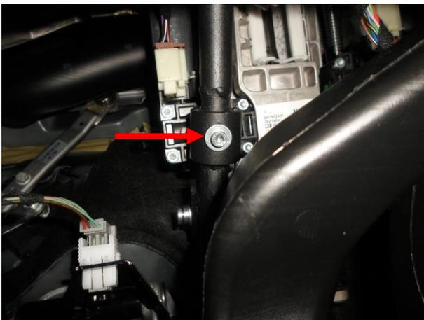
Отрегулировать выход цилиндра из панели и затянуть указанный болт. (оптимально выход цилиндра за пределы панели- 4 мм.)
