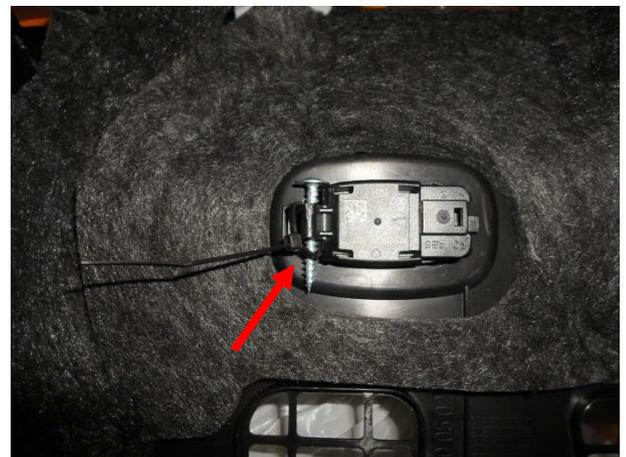
Установить саморез и притянуть его пластиковым хомутом из комплектации.
