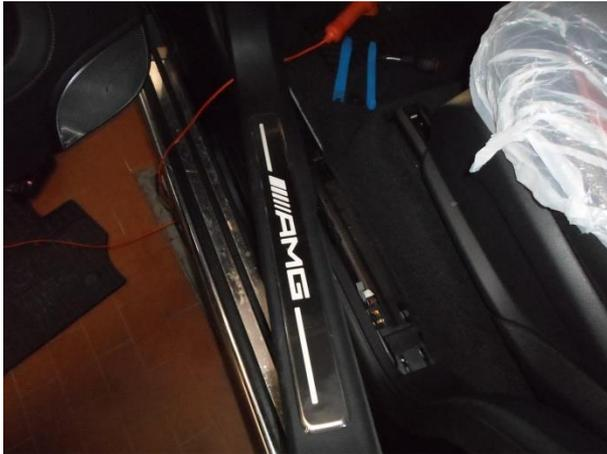
Снять накладку порога. Снять панель и отсоединить фишки.
