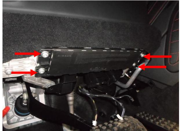
Вывернуть 4 болта и снять airbag.
