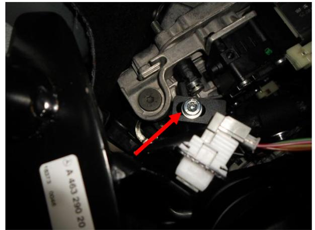
**Для исключения возможности запуска двигателя и перемещения рычага КПП из положения Р при заблокированной педали тормоза, отрегулировать зазор между ригелем и педалью тормоза не более 1 мм.**
