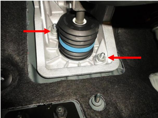
Отвернуть 2 гайки и притянуть нижнее крепление замка срывными гайками.
