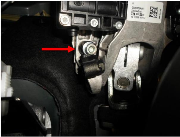
Вывернуть болт крепления рулевой колонки и установить верхнее крепление замка.
