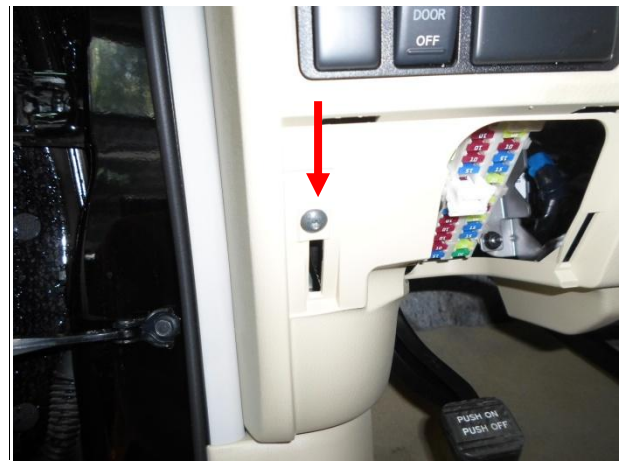
Снять панель и вывернуть саморез.
