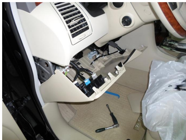
Отсоединить фишки, снять панель.
