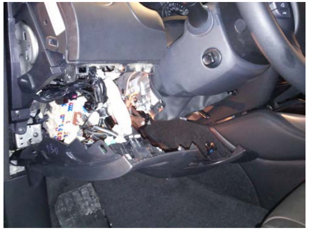
Отсоединить фишки, снять панель.
