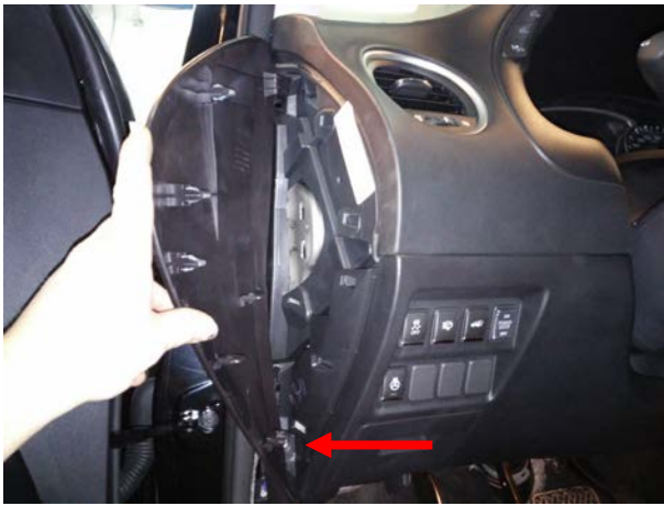
Снять панель, вывернуть саморез.
