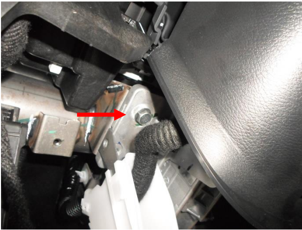
Вывернуть болт крепления рулевой колонки.
