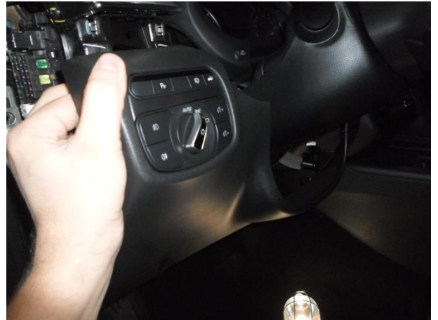
Снять панель, отсоединить фишки.
