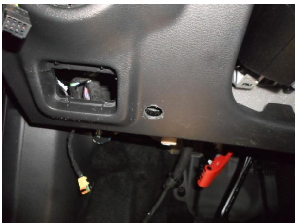
Выполнить отверстие в панели диам. 20 мм.
