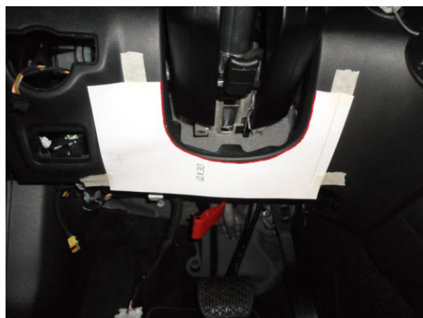
Разметить панель при помощи трафарета.
