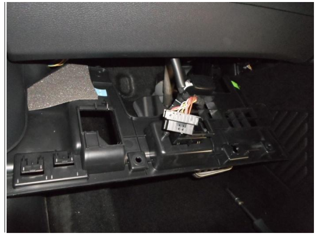
Снять панель, отсоединить фишки.
