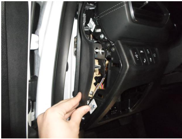
Снять боковую панель.
