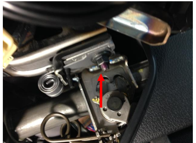
Отвернуть гайку крепления рулевой колонки.
