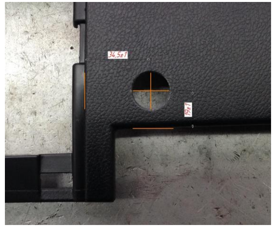
При установке замка без снятия панели предварительно требуется разметить и выполнить отверстие \text{Ø}20 мм. (по горизонтали отступить 34.5\pm 1 мм. по вертикали 19\pm 1 мм.)
