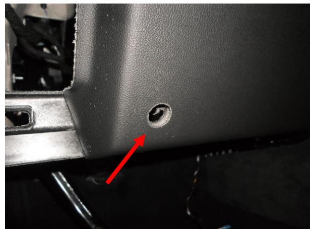
Выполнить отверстие Ø20 мм.
