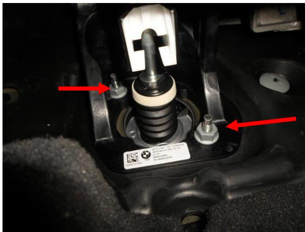
Отвернуть 2 гайки.
