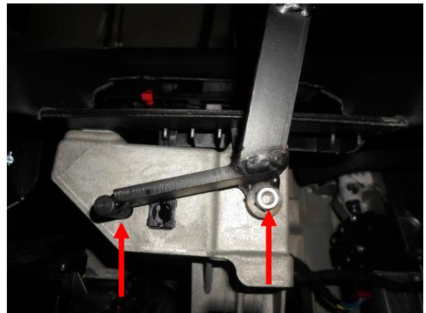
Используя шпильку и отверстие - установить инструмент для разметки панели.
