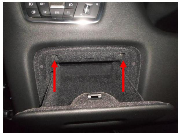
Вывернуть 2 самореза, снять перчаточный ящик.
