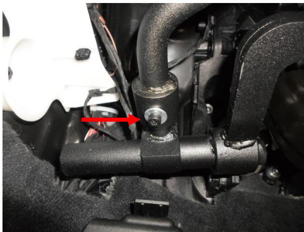
Для исключения возможности запуска двигателя и перемещения рычага КПП из положения Р при заблокированной педали тормоза, отрегулировать зазор между ригелем и педалью тормоза не более 1 мм.
