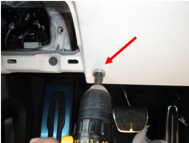
Выполнить отверстие в панели диам. 20 мм.
