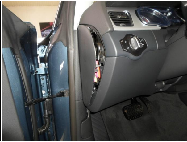
Снять боковую панель.
