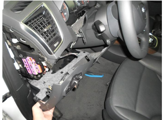
Снять панель, отсоединить фишки.
