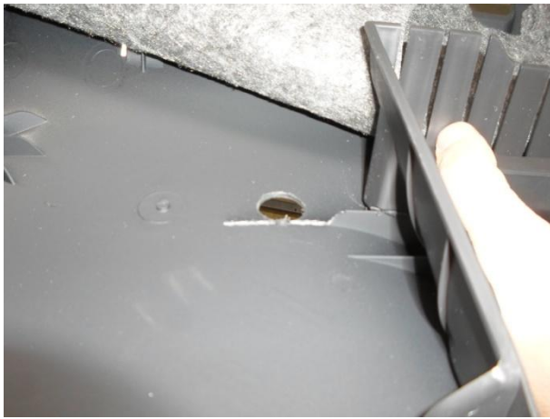
Разметить и выполнить отверстие в панели.
