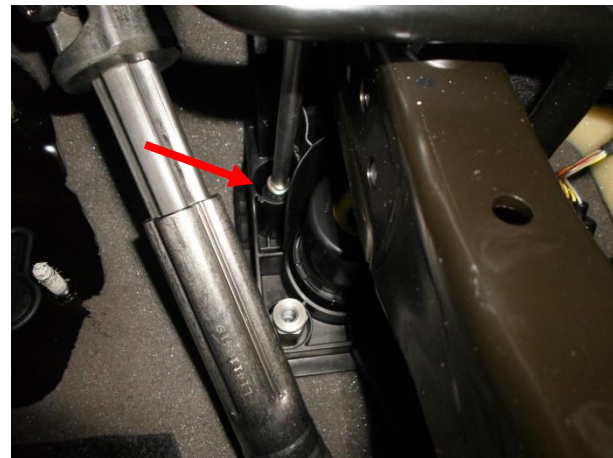
Выкрутить верхнюю гайку крепления вакуумного усилителя...
