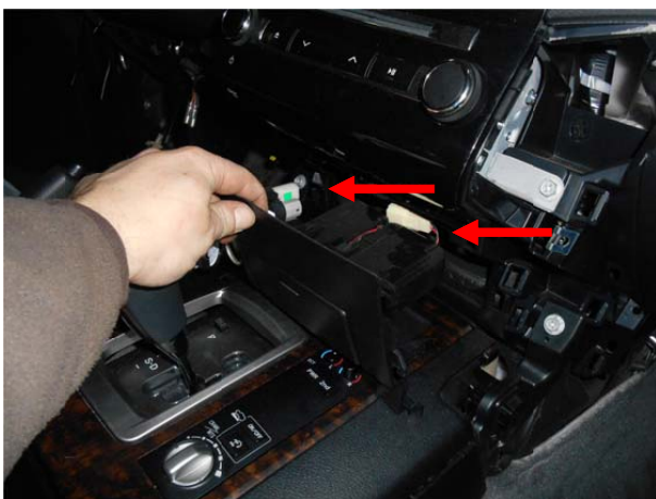
Вытащить пепельницу, отсоединив провода.
