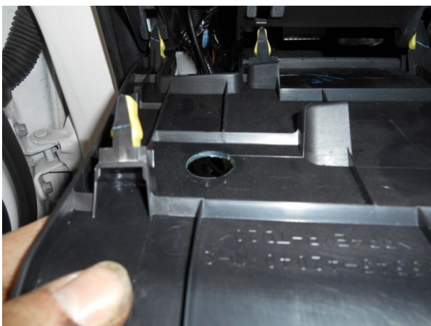
Разметить и выполнить отверстие в панели.
