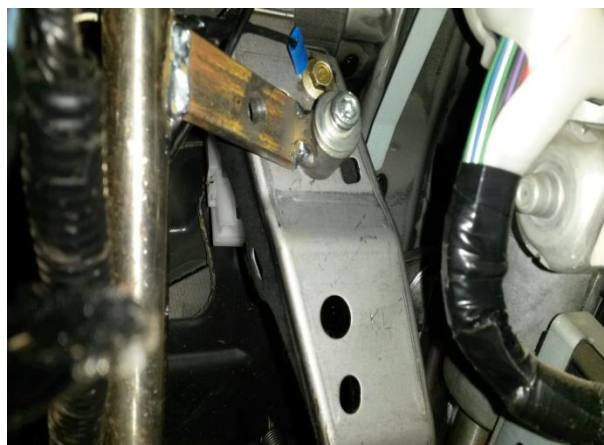
Притянуть верхнее крепление замка.
