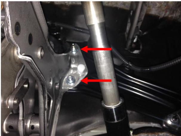
Отвернуть 2 гайки.
