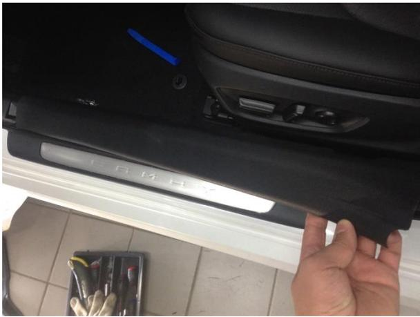
Снять накладку порога.
