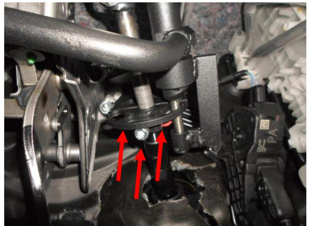
Установить муфту, притянуть срывными болтами. Отрегулировать замок относительно муфты. Проверить свободное вращение рулевого вала при разных регулировках руля, сорвать крепеж муфты и замка.
