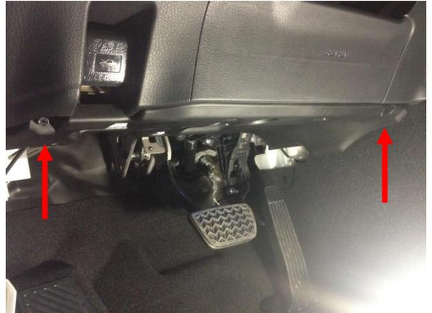
Вывернуть 2 самореза. Снять панель, отсоединить фишки.
