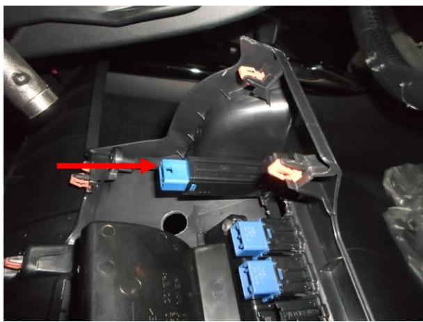
При наличии длинного корпуса клавиши подогрева лобового стекла, требуется перенести клавишу в резервное отверстие под клавиши.
