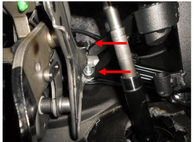
Установить замок и притянуть гайками нижнее крепление.
