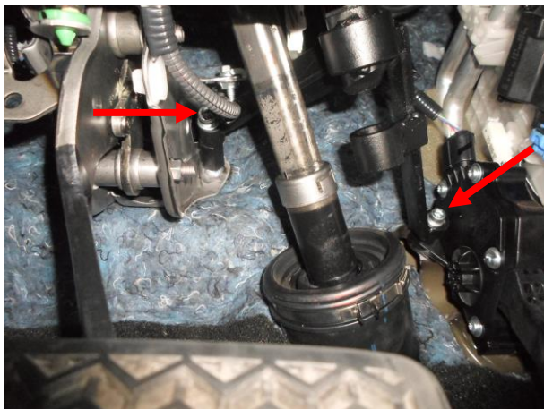
Установить блокиратор, притянуть срывными болтами и гайкой.
