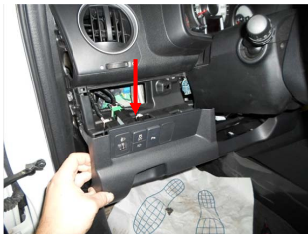
Снять панель под рулевой колонкой, отсоединив разъёмы кнопок.
