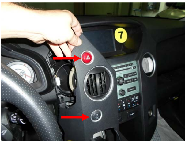
Снять панель, отсоединив разъёмы кнопок.
