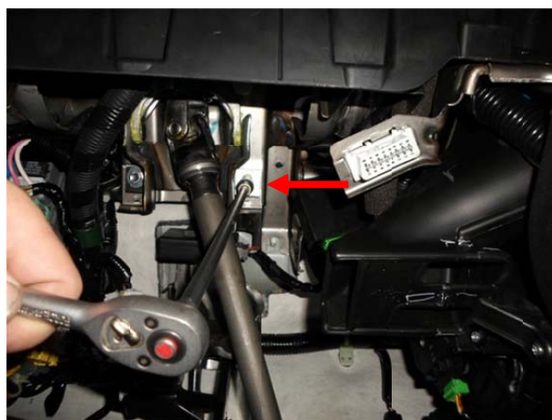
Выкрутить болт крепления рулевой колонки.
