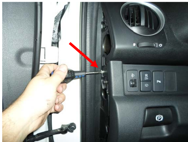
Выкрутить саморез крепления панели под рулевой колонкой.
