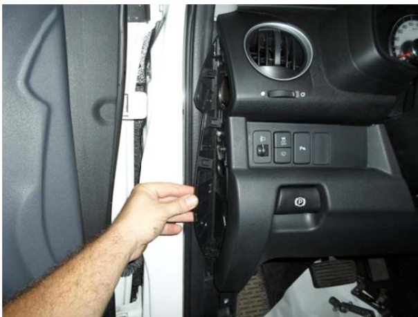
Снять боковую панель.
