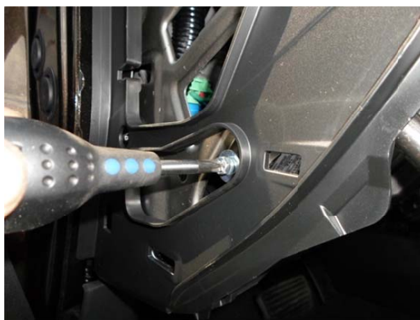
Выкрутить боковой винт крепления блока.
