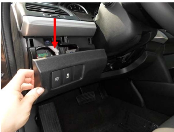
Снять панель под рулевой колонкой, отсоединить разъёмы кнопок.
