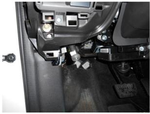
Одеть метку. Наметить центр отверстия под замок. Снять замок и просверлить консоль.
