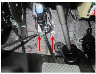
Открутить 2 нижние гайки крепления каркаса педали тормоза.
