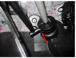
Установить рулевой вал в положение «прямо». Отрегулировать положение блокирующей муфты, проверить свободное вращение рулевого вала при разных регулировках положениях руля, сорвать крепёж муфты и замка.
