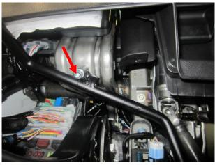
Верхнюю точку крепления замка крепить с помощью гайки, заложенной с внутренней стороны кронштейна. **Крепеж не срывать.**
