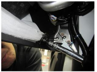
Для удобства установки замка можно выкрутить саморез крепления консоли.
