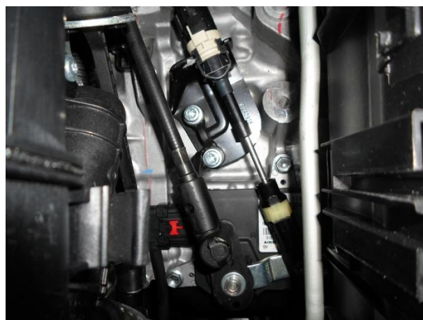
Установить блокиратор, притянуть двумя болтами М8х40.
