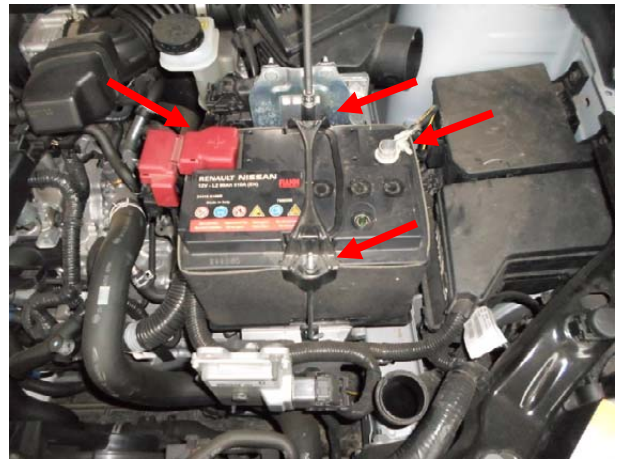
Снять клеммы с аккумулятора, ослабить шпильки крепления аккумулятора и снять его.
