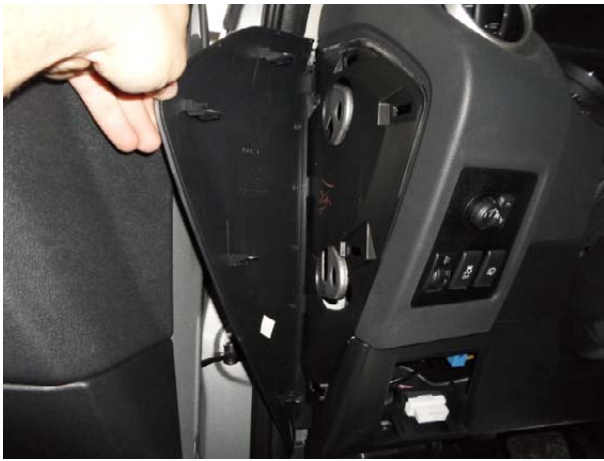
Снять боковую панель.
