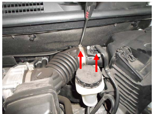
Ослабить хомут воздушного патрубка и снять фишку.
