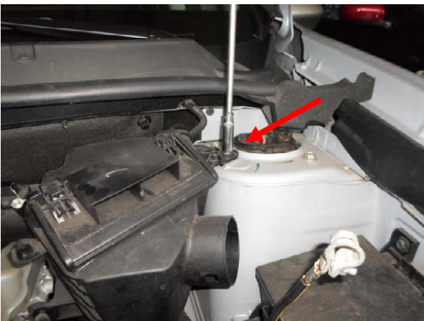
Вывернуть болт крепления корпуса воздушного фильтра
