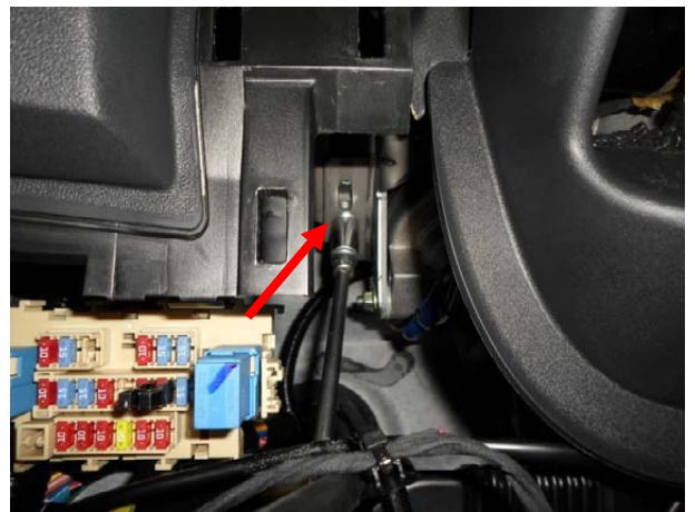
Вывернуть гайку крепления рулевой колонки.
