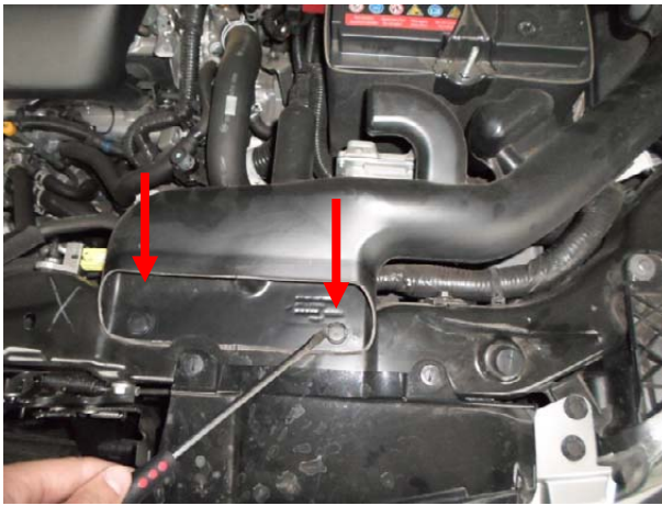
Выдернуть клипсы воздуховода, снять воздуховод.
