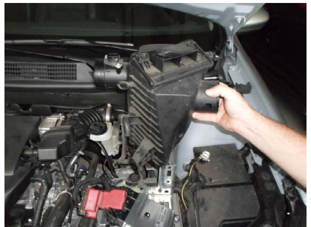
Снять корпус воздушного фильтра.
