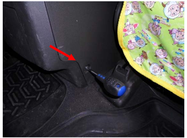
Выкрутить 2 задних самореза центрального тоннеля справа и слева.
