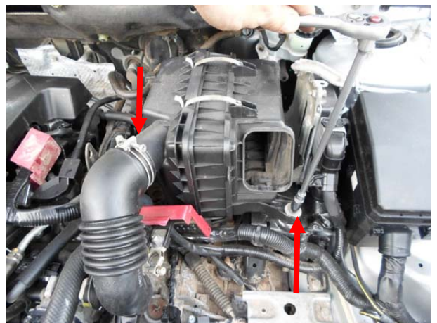
Вывернуть болт крепления корпуса воздушного фильтра, ослабить хомут воздушного патрубка.
