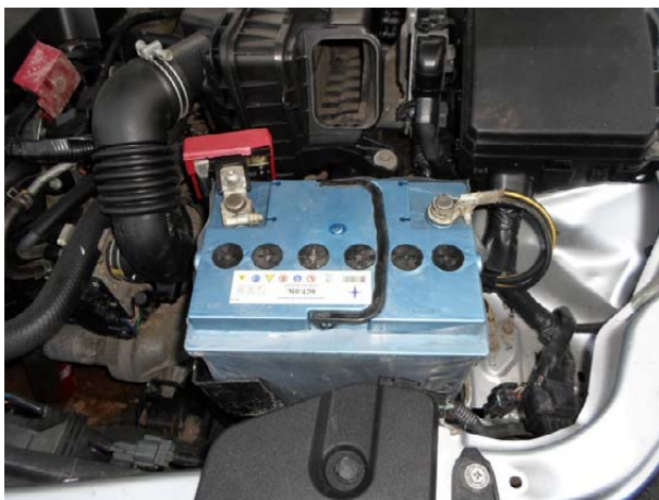
Открутить клеммы АКБ; вытащить АКБ; вытащить площадку АКБ.
