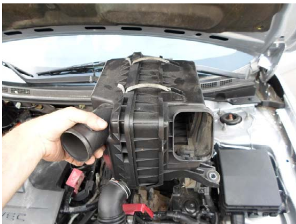
Снять корпус воздушного фильтра.
