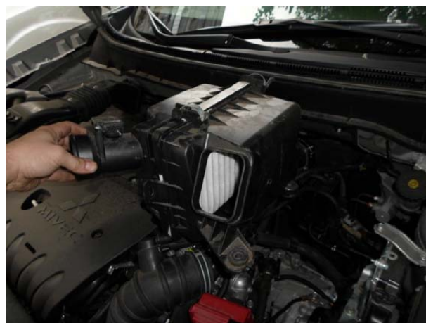
Снять корпус воздушного фильтра.
