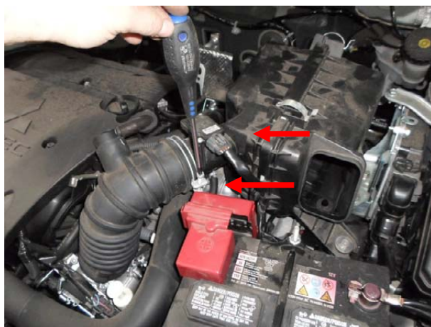
Снять фишку, ослабить хомут воздушного патрубка.
