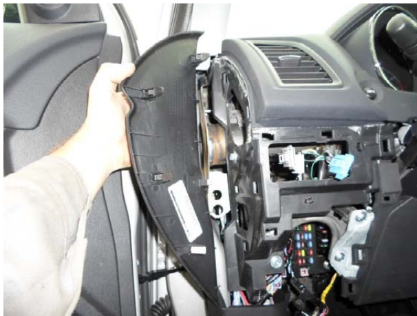
Снять боковую панель.
