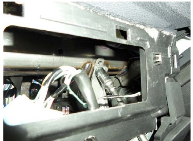
Открутить гайку и затянуть срывную.
