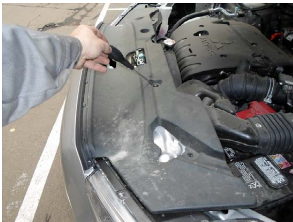
Выдернуть клипсы накладки, снять накладку.
