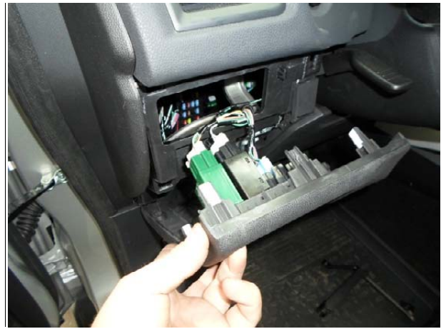
Снять панель и отсоединить все фишки.
