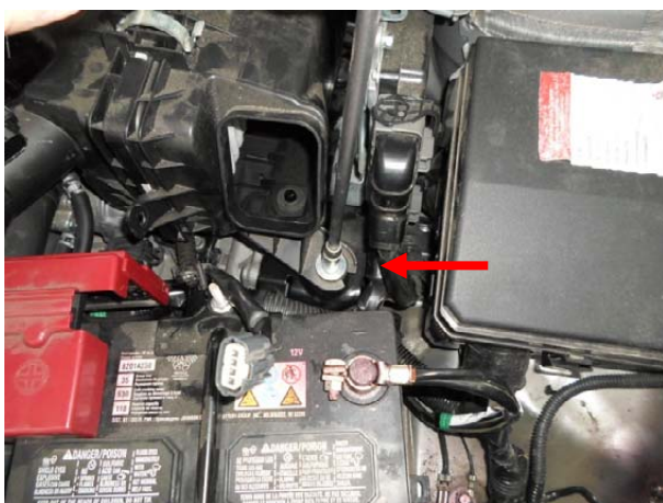
Вывернуть болт крепления корпуса воздушного фильтра
