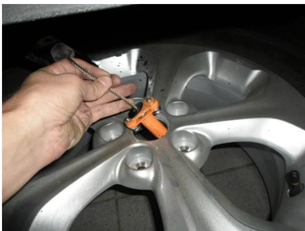
При установке запасного колеса вставляем защитный элемент. (в сборе)
