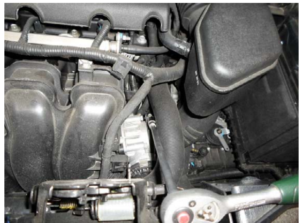
Ослабить нижнее крепление хомута воздушного патрубка.
