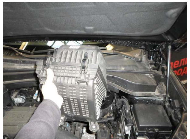
Снять воздушный фильтр.
