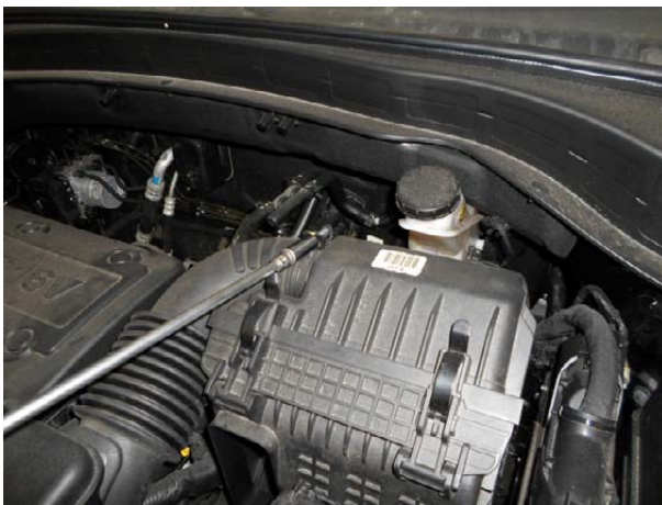
Ослабить верхнее крепление хомута воздушного патрубка.
