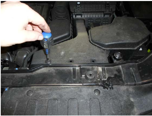
Вывернуть 3 клипсы крепления воздухозаборника.
