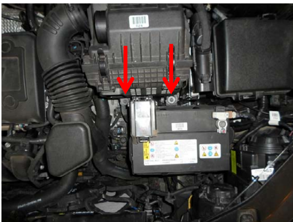
Вывернуть болты крепления воздушного фильтра.
