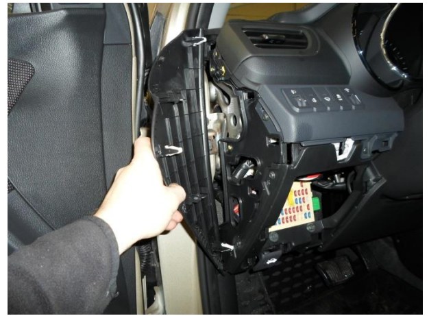
Снять боковую панель.
