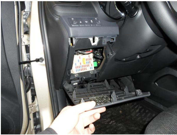
Снять крышку блока предохранителей.
