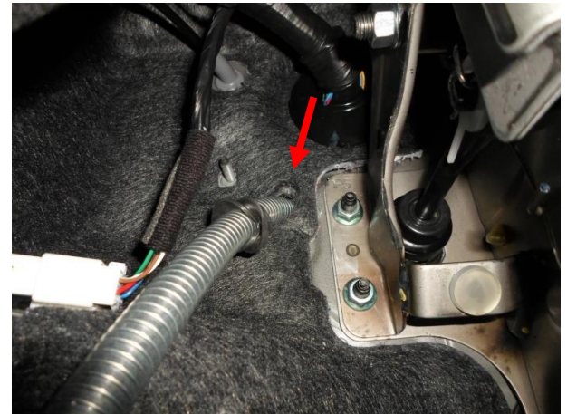
Выполнить отверстие в моторном щите и провести оболочку с замковым механизмом. Одеть уплотнительное кольцо на оболочку.
