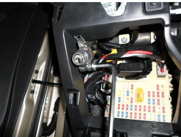
Установить замковый механизм в кронштейне, притянуть его срывным болтом М8х20. Поворотом замкового механизма добиться нулевого выступа ригеля из корпуса, проверить лёгкость работы замка.
