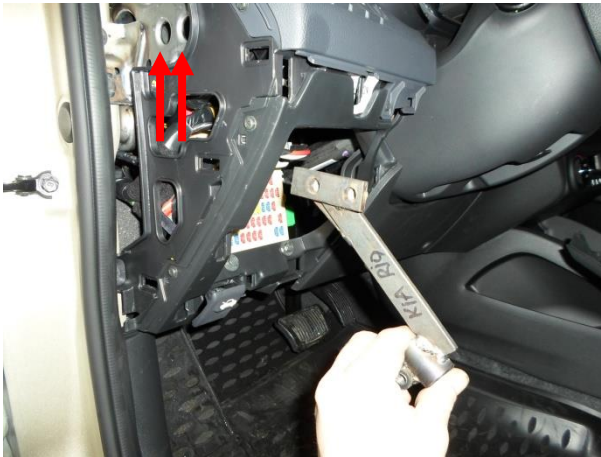
Установить кронштейн замка. Установить кронштейн совместно с его крышкой и притянуть срывными болтами.
