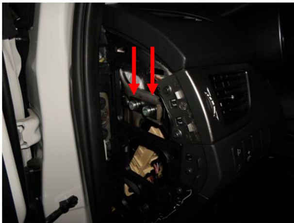
При установке кронштейна использовать пластину с втулками (крышка). Притянуть болтами М8х25.
