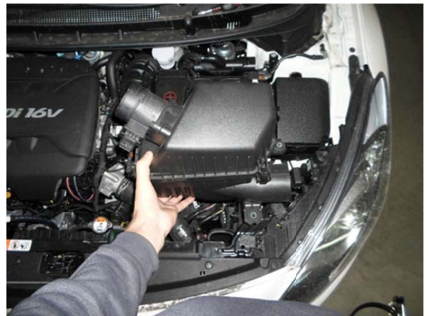
Вытащить корпус воздушного фильтра.
