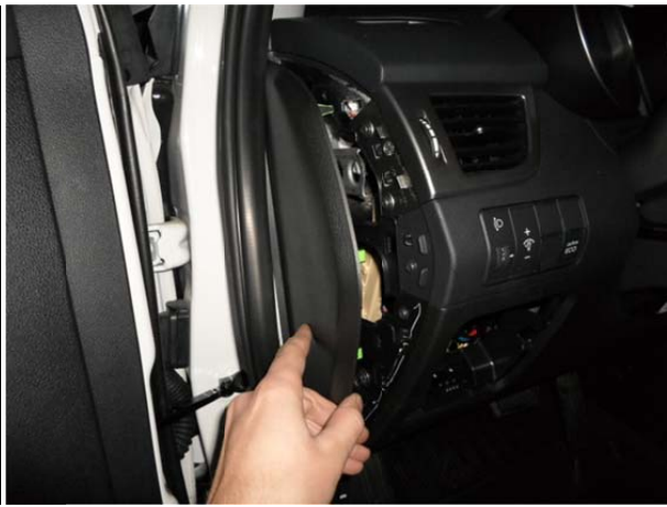
Снять боковую панель.
