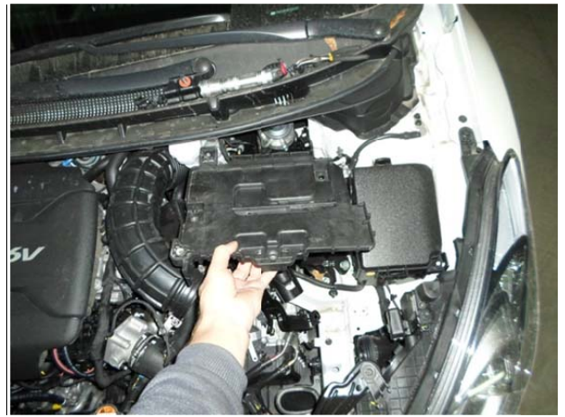
Вытащить площадку АКБ.
