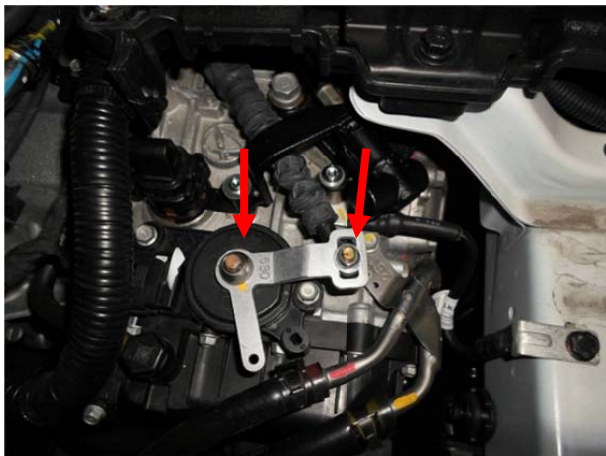
Установить блокиратор притянув болтами M6x30 и M8x35. Заменить гайки крепления флажка выбора режимов АКПП на срывные.
