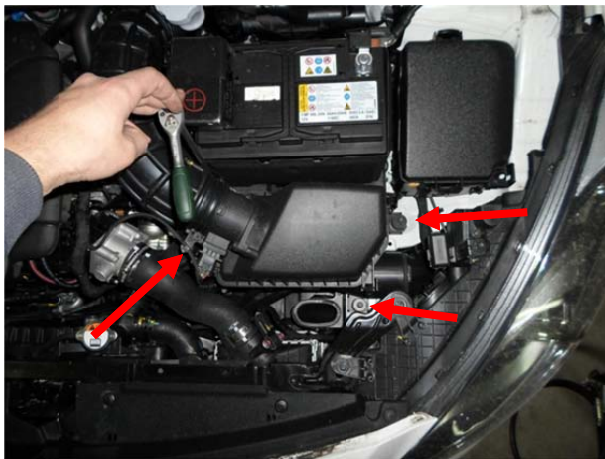
Ослабить хомут воздушного патрубка, вывернуть болты крепления корпуса воздушного фильтра, снять фишку.
