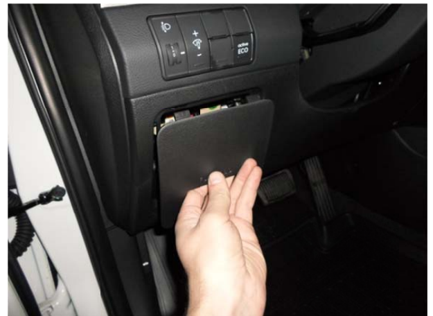
Снять крышку блока предохранителей.
