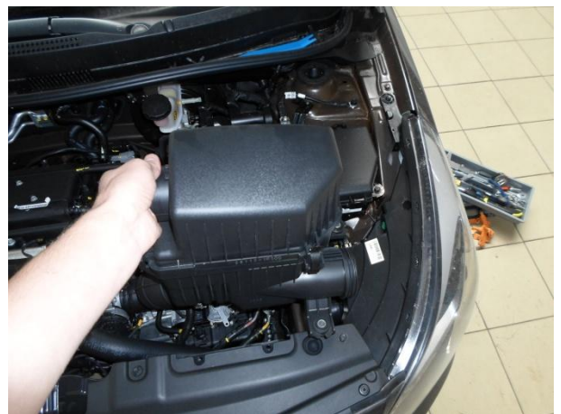
Вытащить корпус воздушного фильтра.
