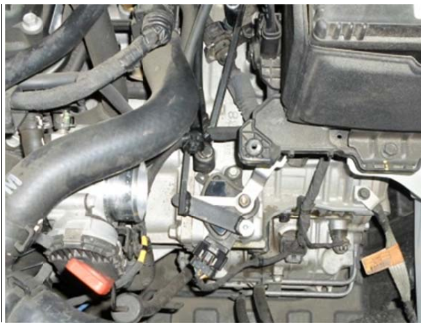
Установить кронштейн с блокиратором, проложив в точках крепления под ним шайбы, притянуть болтами М8х70 и М6х45 с шайбами. Жгут притянуть хомутом к кронштейну.
