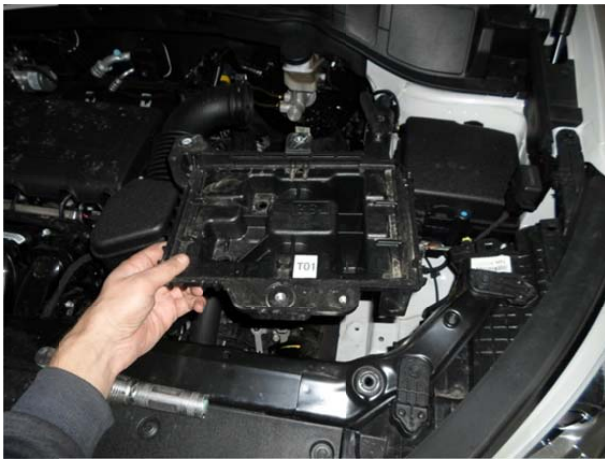
Вытащить площадку АКБ.
