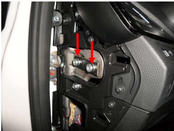
При установке кронштейна использовать пластину с втулками (крышка). Притянуть болтами M8x25.
