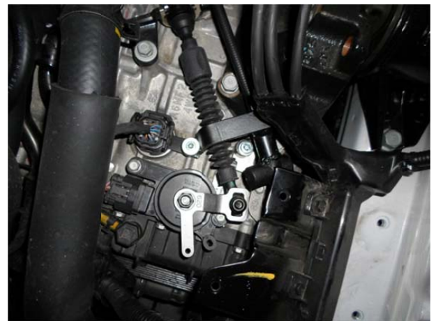
Установить кронштейн с блокиратором и притянуть его болтами М8х35 и М6х30 с шайбами.
