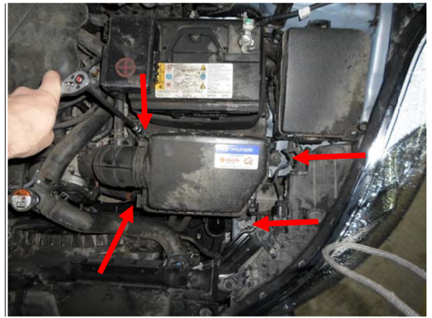
Вывернуть три болта крепления корпуса воздушного фильтра, ослабить хомут воздушного патрубка.
