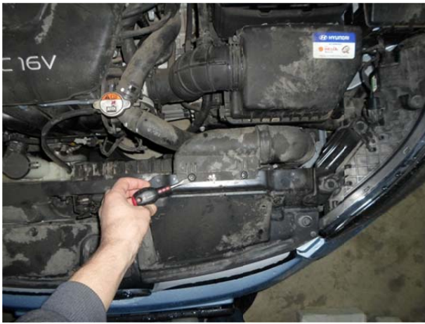
Выдернуть 2 клипсы воздухозаборника и снять его.
