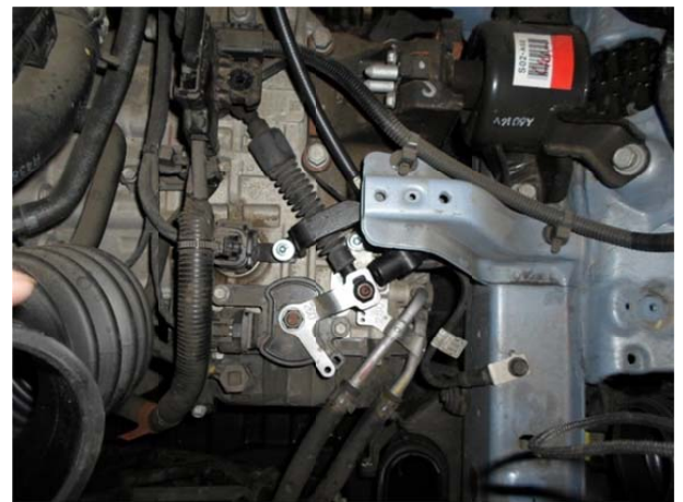
Установить блокиратор притянув его болтами М6х30 и М8х35. Заменить гайки крепления флажка выбора режимов АКПП-срывными.
