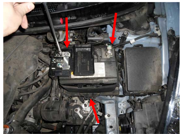
Ослабить клеммы АКБ, ослабить крепеж АКБ, снять АКБ.
