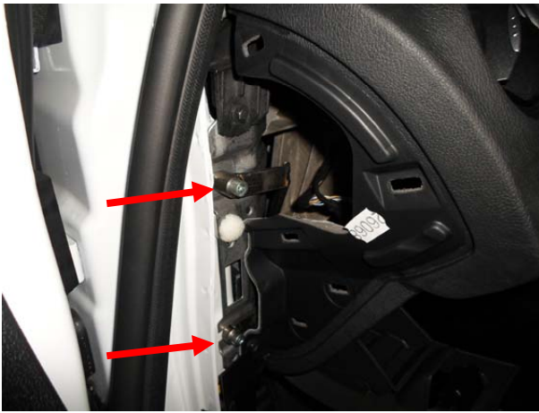
Притянуть кронштейн срывными болтами.
