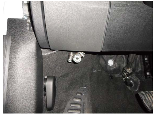
Провести оболочку с замковым механизмом в салон через отверстие в заглушке. Одеть уплотнительное кольцо на оболочку. Установить замковый механизм в кронштейне, притянуть его срывным болтом. Поворотом замкового механизма добиться нулевого выступа ригеля из корпуса, проверить лёгкость работы замка.
