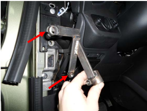
Установить кронштейн замка, вставив изнутри панели приборов, притянув срывными болтами
