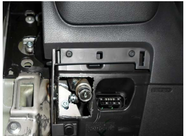
Провести оболочку с замковым механизмом в салон через отверстие в заглушке. Одеть уплотнительное кольцо на оболочку. Установить замковый механизм в кронштейне, притянуть его срывным болтом. Поворотом замкового механизма добиться нулевого выступа ригеля из корпуса, проверить лёгкость работы замка. Одеть метку и разметить крышку предохранителей.
