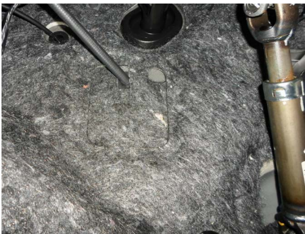
Разрезать шумоизоляцию под оболочку и установить на место
