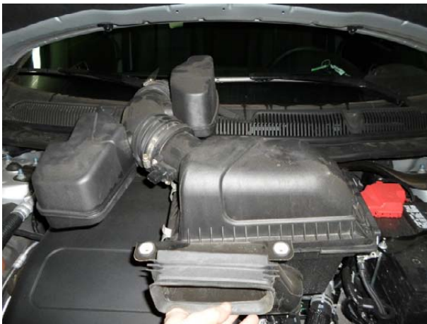
Снять воздушный фильтр
