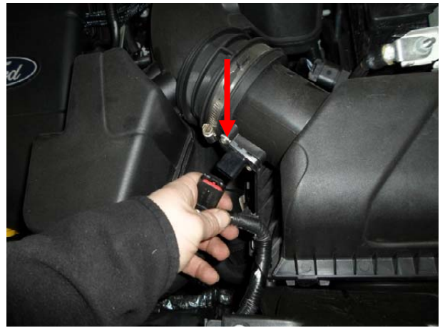
Снять разъем с датчика
