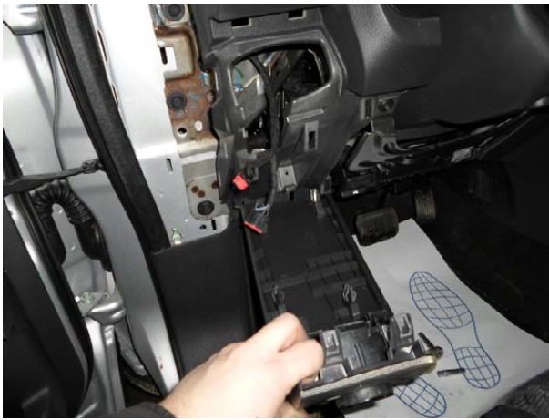
Отсоединить разъёмы и снять малую панель
