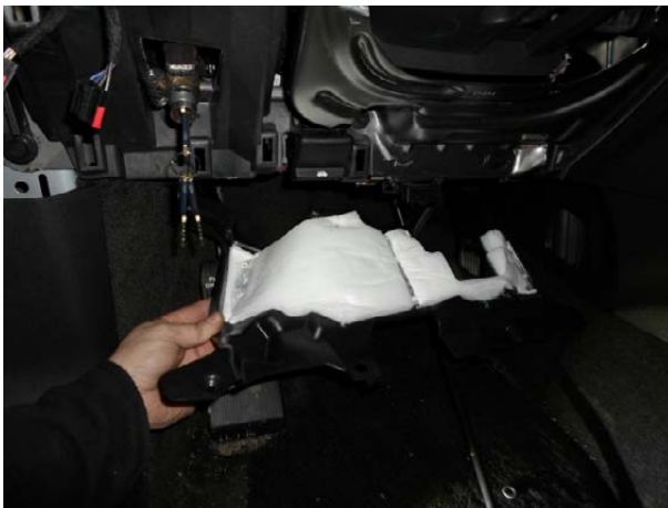
Снять крышку под рулевой колонкой
