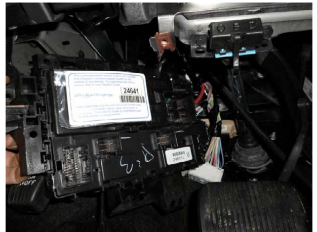
Отсоединить колодки и снять коробку с разъёмами
