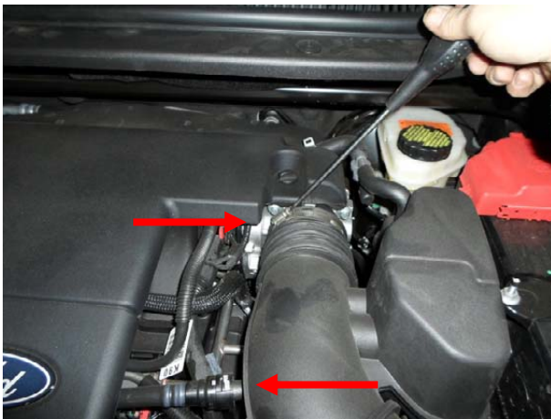
Ослабить хомут и снять патрубок
