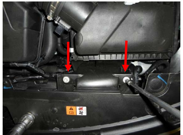
Выкрутить 2 винта переднего крепления воздушного фильтра
