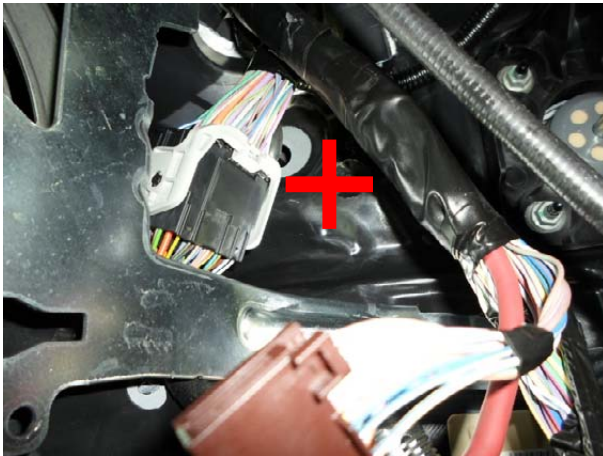
Выполнить отверстие в моторном щите рядом с тросом открывания капота
