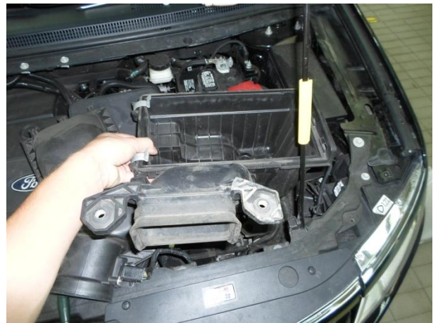
Вытащить нижнюю часть корпуса воздушного фильтра.
