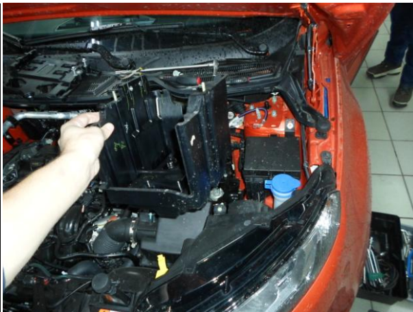
Вытащить площадку АКБ.
