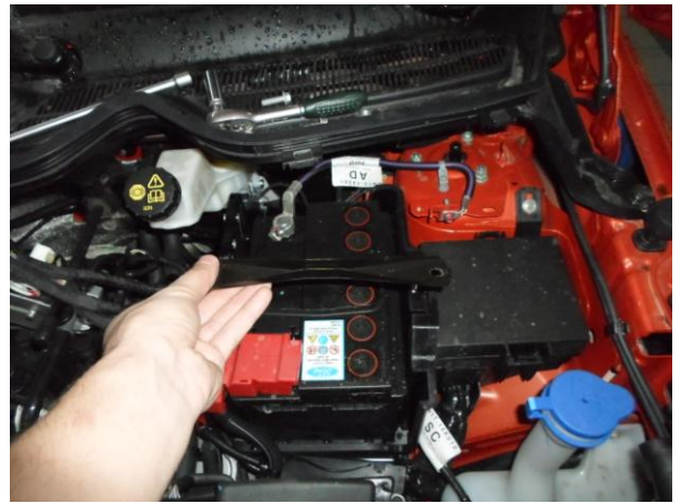
Снять крепление АКБ.
