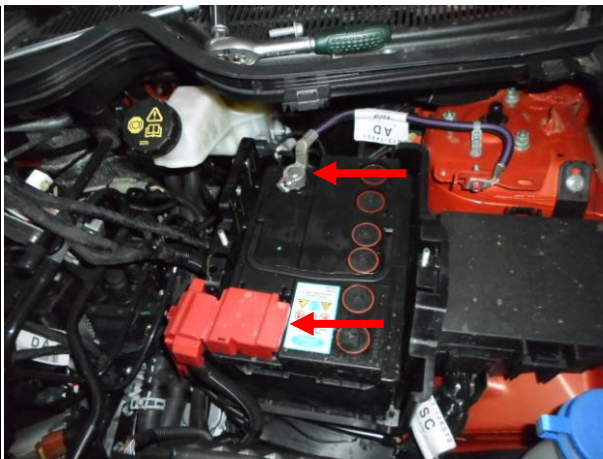
Снять клеммы АКБ. Вытащить АКБ.
