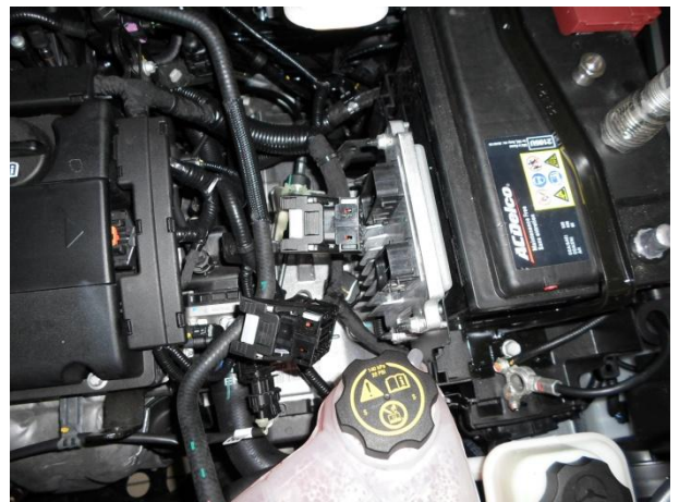
Снять фишки с ЭБУ.
