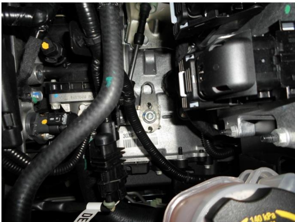
Установить дополнительный флажок и притянуть срывной гайкой M10.
