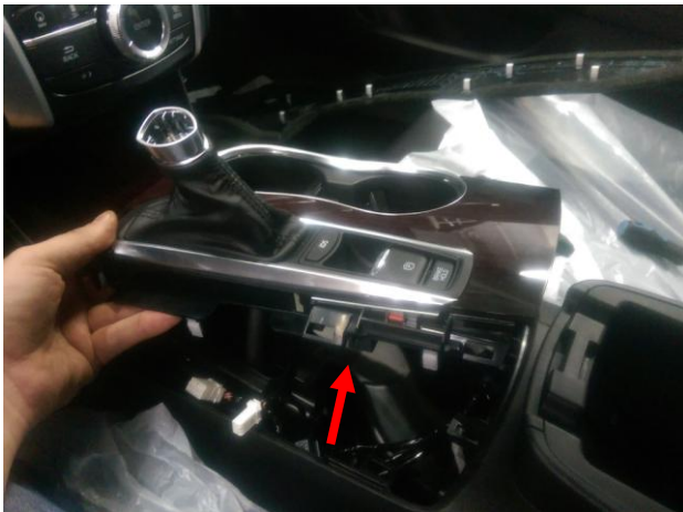
Снять центральную панель, отсоединив разъёмы.
