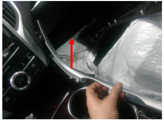
Снять две боковые накладки центральной панели, отсоединив разъёмы.
