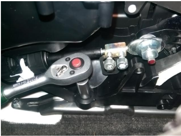
Выкрутить болт крепления корпуса кулисы
