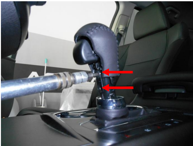
Выкрутить 2 винта крепления рычага КПП. Снять ручку рычага КПП.
