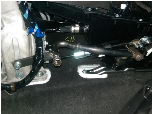
Выкрутить болт крепления корпуса кулисы
