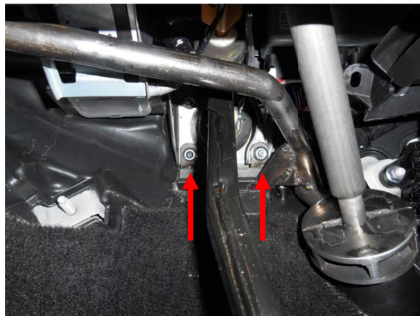
Установить замок, подложив под нижние точки крепления по 2 широкие шайбы с каждой стороны. Установить муфту на рулевой вал, стянув болтами. В случае касания блокиратором муфты – убрать широкие шайбы.
