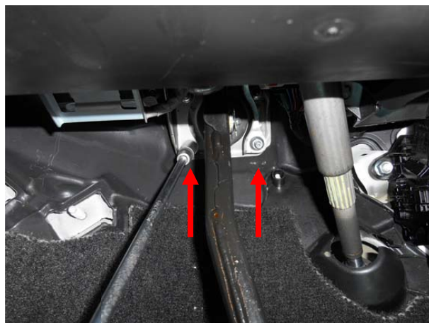
Открутить 2 нижние гайки крепления каркаса педали тормоза.
